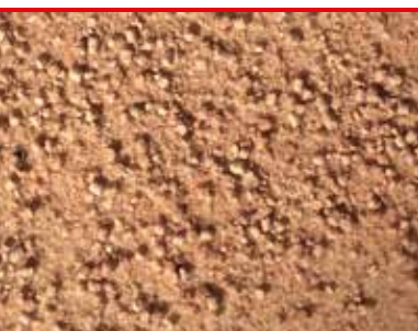
i 3 Husbock - borrmjöl med karakteris- tiska vinkork-formade ekskrement (foto - Protox/Goritas arkiv)
