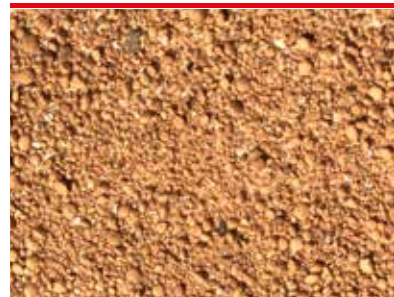
Skäckig trägnagare - linsformade exkrementer borrhjöl (foto - Protox/Goritas arkiv)
