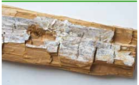
svn 34 Mögelticka- vitt ytmycel på angripet virke med sprickklossar (foto - Protox/Goritas arkiv)
