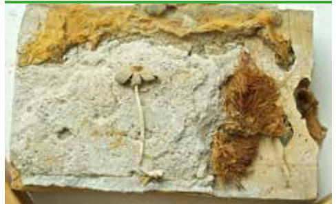
svn 20 Vedbläcksvamp - fruktkroppar (hatt och fot) och orangea-brunt, segt, koksmattaliknande ytmycel (foto - Protox/Goritas arkiv)
