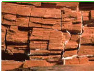
Brunröta - svampen nedbryter cellulosa-fiberna och kvarlämnar ligninet
