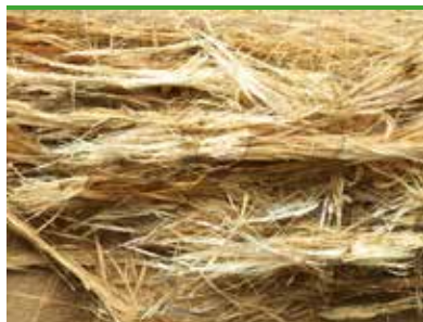
Vitröta - svampen nedbryter ligninet i träet och kvarlämnar cellulosa-trådarna. Därmed trådar virket.
