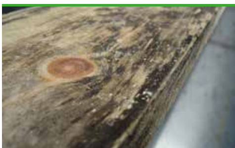
svn 60 Blånad och svartmögel på barrträ (foto - Protox)
