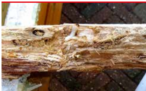
in 15 Röd blombock- larv, bormjöl och nedbrutet trä (foto - Protox/kundefoto)
