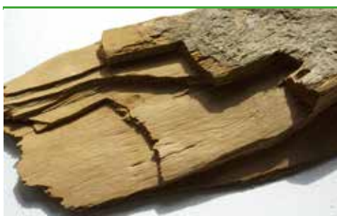
svn 42 Pulverskinn - brunmögel, bladig nedbrytning. Värderas som svampskada (foto - Protox/Goritas arkiv)
