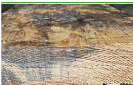
svn 59 Blånad - angripet barrträ i mörkstrålar från ytan till träets kärna (foto - Protox)
