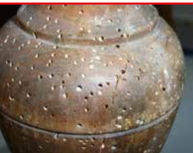
i 10 Strimmig trägnagare - flyghål i bordsben (foto - Protox)
