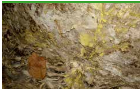
svn 25 Äkta Hussvamp- ytmycel med karakteristiska gula fläckar (foto - Protox)
