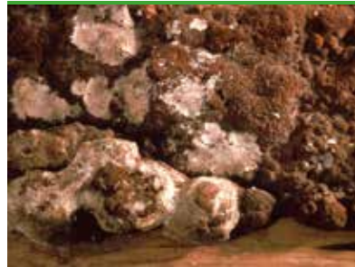
Korkmussling - sterila fruktkroppar/brunt ytmycel utvecklade i mörker på platt tak. (foto - Protox/Gori A/S)
