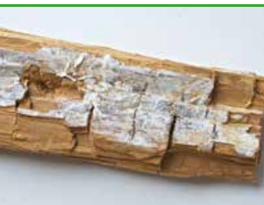
sv 13 Timmerticka- nedbrutet virke (brunnröta) och ytmycel (foto - Protox/Goritas arkiv)
