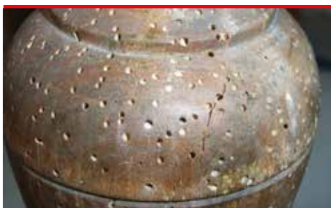
in 17 Strimmig trägnagare- flyghål i bordsben (foto - Protox)
