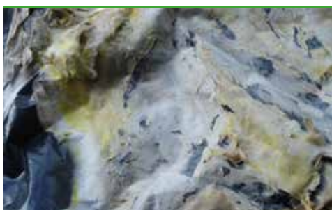
svn 30 Äkta Hussvamp- ytmycel med karakteristiska gula fläckar (foto - Protox)
