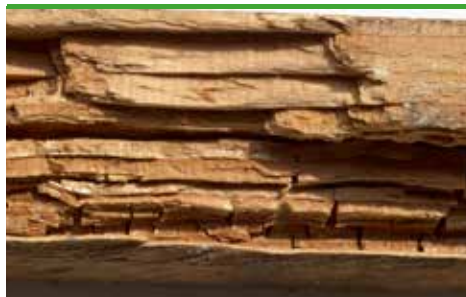
svn 43 Knöliticka (Mögelicka) - nedbrytning (foto - Protox)
